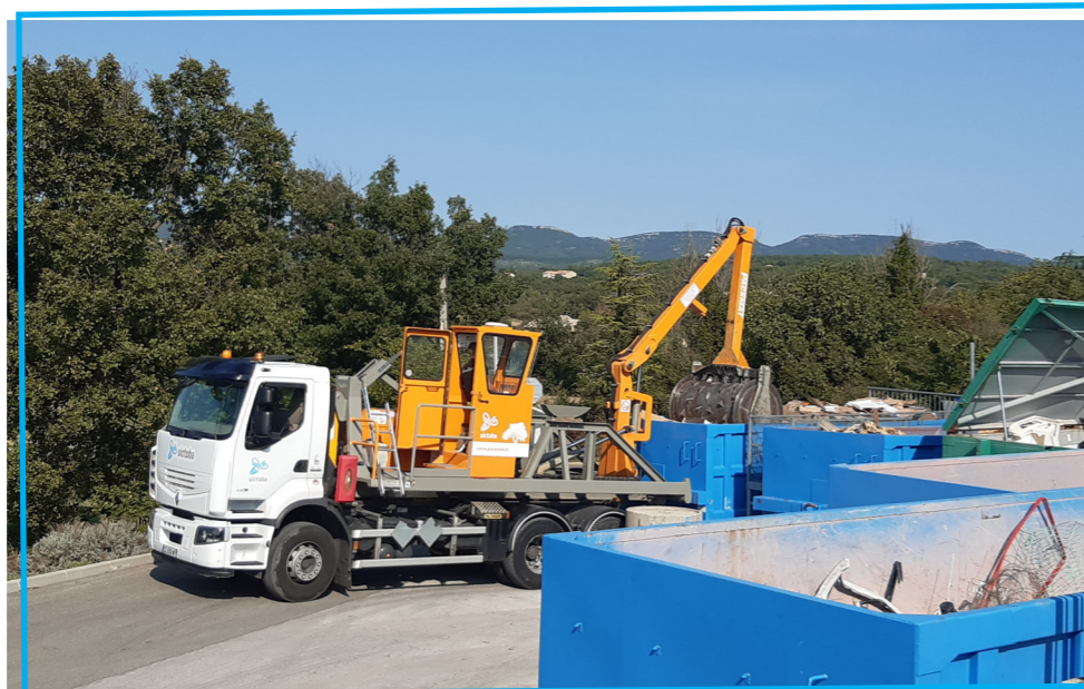
Le Packmat tassant une benne à la déchetterie de Barjac
